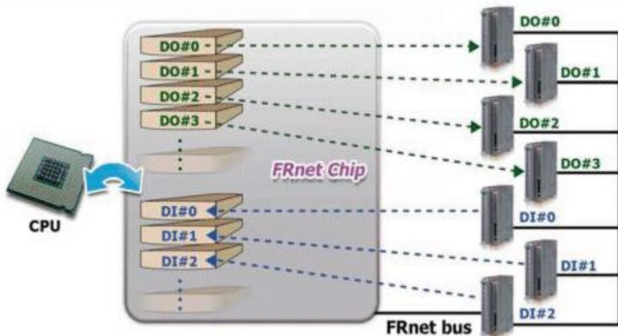
**Многоточечная сеть до 128 каналов ввода и 128 каналов вывода.**
